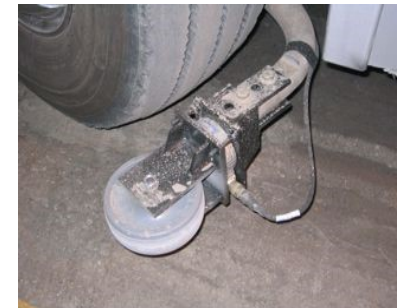
בתמונה: חיישן התראה ליד גלגל האוטובוס המודיע לנהג מתי הגיע לקרבת המדרכה
